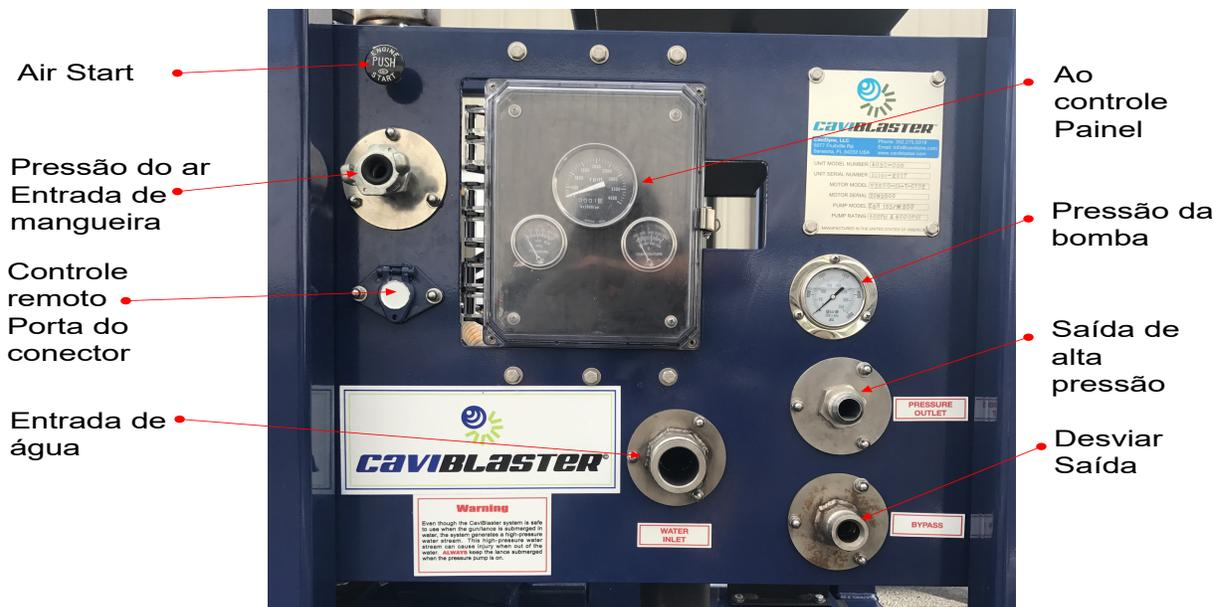
Figura 2.2 - Painel de conexões CaviBlaster 4030-DOS
