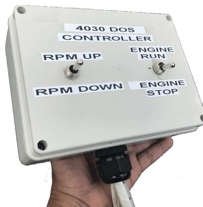
***Figura 5.1 - Caixa do controle remoto (RCB)***
